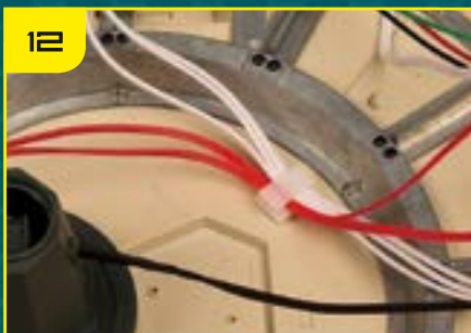
Вторую клипсу приклейте к внутренней стороне турели и зафиксируйте с ее помощью проводку передних огней и электрики трапа.
