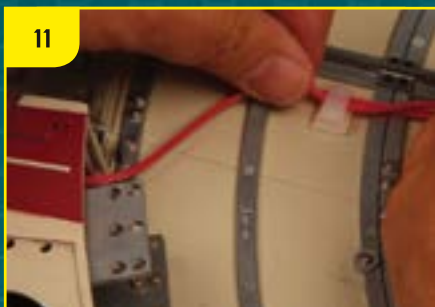
Приклейте первую клипсу к внутренней стороне обшивки между «жвалами» и зафиксируйте с ее помощью проводку передних огней.
