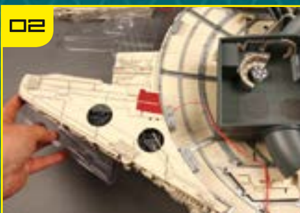
Установите «жвало» на опору и совместите его с корпусом модели. С помощью болтов отрегулируйте высоту и угол положения модели.
